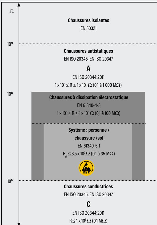
A et C : Exigences supplémentaires en matière de propriétés électriques pour les chaussures professionnelles et de sécurité. R : résistance électrique.  $R_y$  : résistance de mise à la terre.
